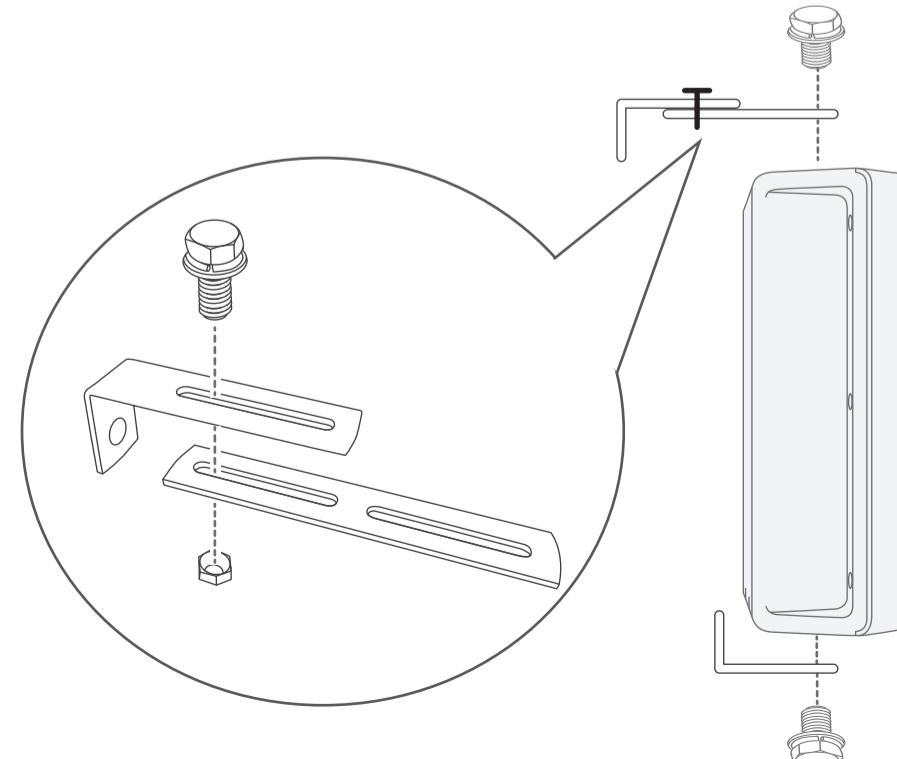
2、将挂墙支架置于选定的墙面处，将螺钉孔定位贴贴于墙面。若不安装延长支架，音柱与竖直方向平行；若安装延长支架，音柱与竖直方向呈21°夹角。按照标贴上的打孔位置，用冲击钻在墙面上钻出安装孔。
